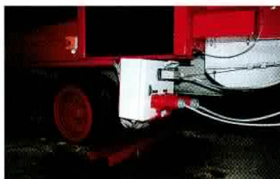
När man kör iväg med vagnen rycks alla tre kontaktarna loss automatiskt. En markering i golvet hjälper sedan föraren att placera vagnen rätt när den kommer tillbaka fylld.
